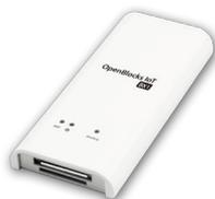
OpenBlocks IoT BX3 に PD Emitter を搭載。IoT デバイスからデータを受け取り、クラウドサーバーへデータを送信します。極小サイズで設置場所に困らず、3G・Wi-Fi 通信や Bluetooth などの無線通信モジュールを内蔵しており、クラウドサーバーとの通信を容易に実現します。
