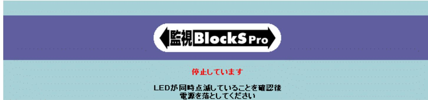
4. ステータスインジケータ 1,2,4 が全て点滅になったら AC アダプタを抜いて下さい。
