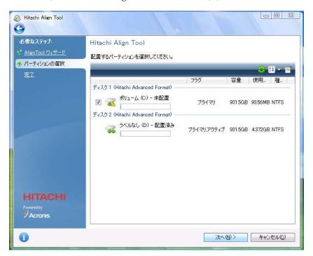
5. OS 起動後、"Hitachi Align Tool"を起動し「配置済み」となっていることを確認する。
