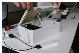
各種センサーの入ったボックスと OpenBlocks IoT BX1
