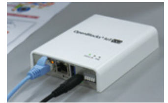
(左)HibeaconとビーコンレシーバーのOpenBlocks IoT BX0 (右) ビーコンサーバーのOpenBlocks IoT VX2
