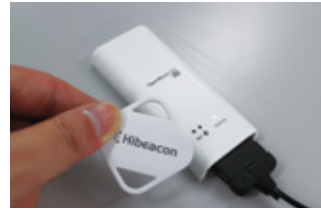
(左)HibeaconとビーコンレシーバーのOpenBlocks IoT BX0 (右) ビーコンサーバーのOpenBlocks IoT VX2
