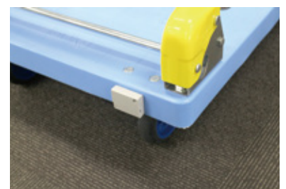
台車へのビーコン（発信機）の取付例
