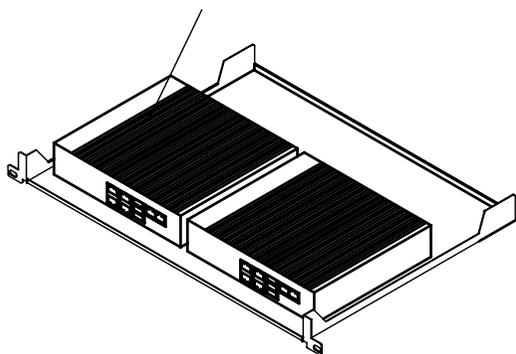
2. 上ケースを図のネジ穴を使用して、ラックに取り付けます。
