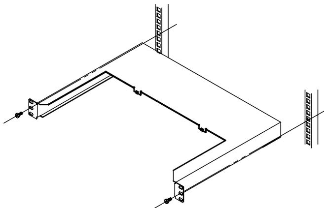
3. 上ケースを下ケースに挿し込み、ネジ止めします。
