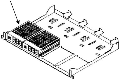
2. ACアダプタのラベル面を上にして下ケースの枠に合わせて乗せ、DCコードをOpenBlocks本体に接続します。
