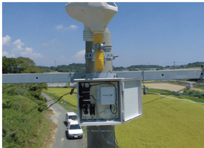
風速計のデータをクラウドへ送信する OpenBlocks。 風速が一定以上になると高所作業が出来ない。 事業場からの遠方地に限り常時監視を行っている。
