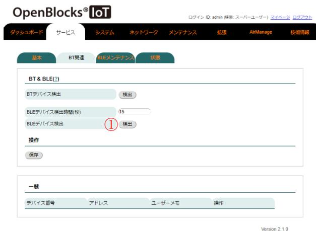
BLE センサーデバイスの電源を入れ、「BLE デバイス検出」の検出ボタン①を押してください。
