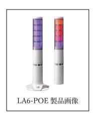
従来、表示灯の色やその並び順を変更する際、各色のカラーグローブがついた LED ユニットを取り換える必要があり、色の種類も限定的でしたが、Modbus/TCP による LAN 通信で制御可能となったことにより、そういった取り換え作業なく、21 色を様々な動作モードで制御できるようになり、情報伝達力が格段に向上致しました。
